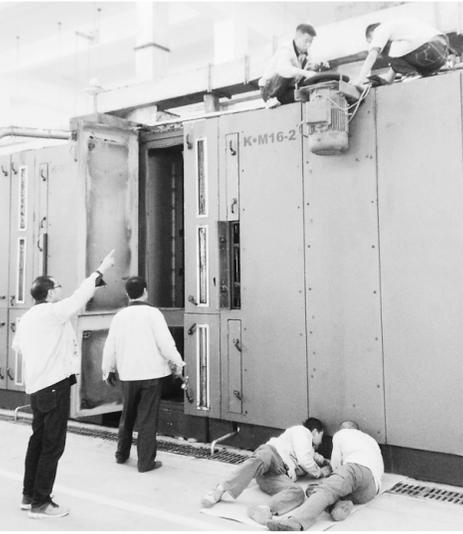
染整厂设备人员正在检修克朗茨烘干机 方向军摄
